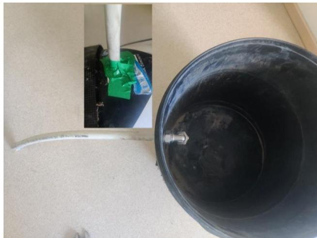
3. Perfore un agujero en el centro de la tapa del cubo. El tamaño del taladro debe ser acorde con la conexión utilizada.
