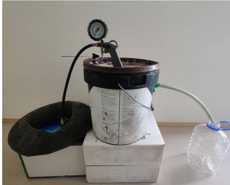
7. Al cabo de 7-10 días el proceso se ha completado. Cierre la válvula de la cámara de aire, abra la tapa y añada material orgánico al digestor. El gas extra también estará en el contenedor. A través del aliviadero se recoge el digestato rico en nutrientes que puede utilizarse como abono.
